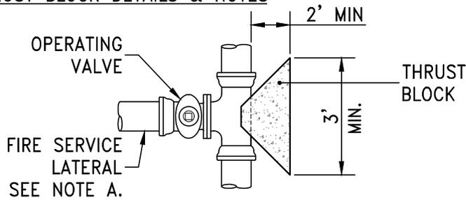
**THRUST BLOCK AT OPERATING VALVE - PLAN VIEW**
